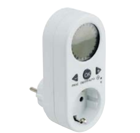
Digitaltimer klocka 24h Idealisk för energispar och säkerhet i hemmet eller på kontoret. Enkel inställning av program. 48 ON/OFF per dygn. Manuell ON/OFF-knapp. Batteribackup. 230V. 50Hz. IP20. Vit, petskyddad. Max 1800W. Jordad.
