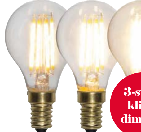
LED-lampa E14 P45 3-step Click LED-lampa med 3-steps klickdimring! Ljusstyrkan ändras enkelt genom slå av och på strömbrytaren. Välj mellan 40lm, 200lm eller 400lm. Ljuskval är 2100K och den har E14-sockel. Startar alltid på lägsta ljusstyrka. IP44. Energiklass: A++.
